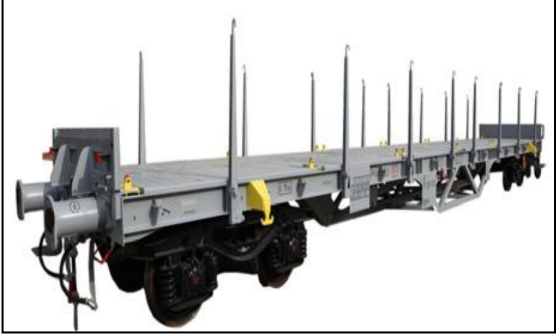
Şekil 5.8: Hafifletilmiş yük vagonu
