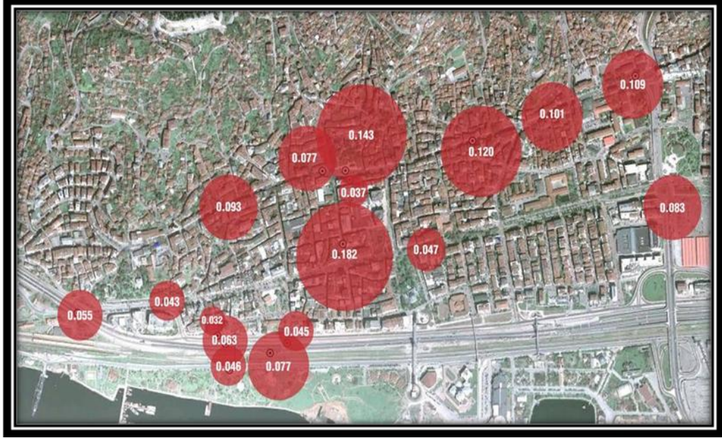
Şekil 4.2 : Otobüs duraklarında partikül madde maruziyet ölçüm değerleri
