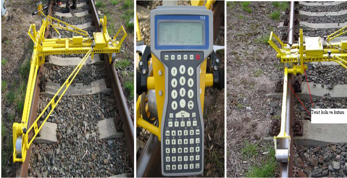
Şekil 5.8: Hat geometrisi ölçüm cihazı ve el bilgisayarı
