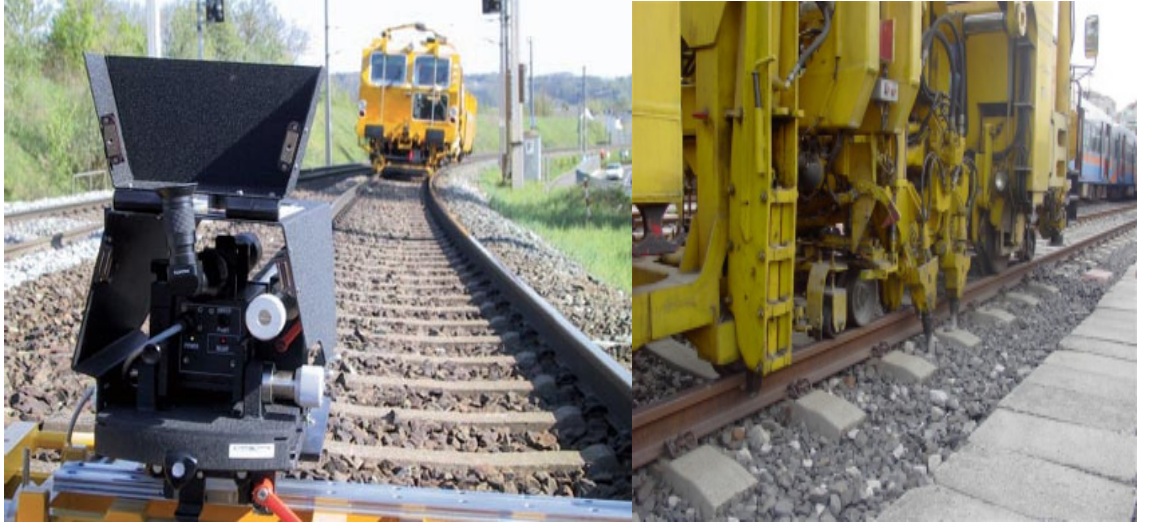
Şekil 6.39: Buraj makinasının çalışması
