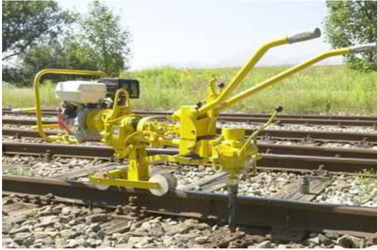
Şekil 5.6: Trifonöz makinesi ile somun sıkma
