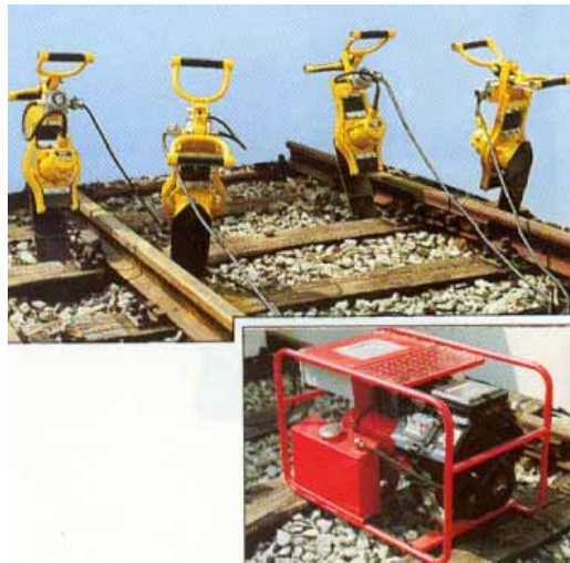
Şekil 6.38: El buraj aletlerinin traverse dizilişi
