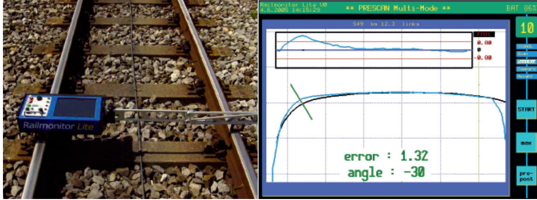
Şekil 5.12: Lazerli profil ölçüm aleti
