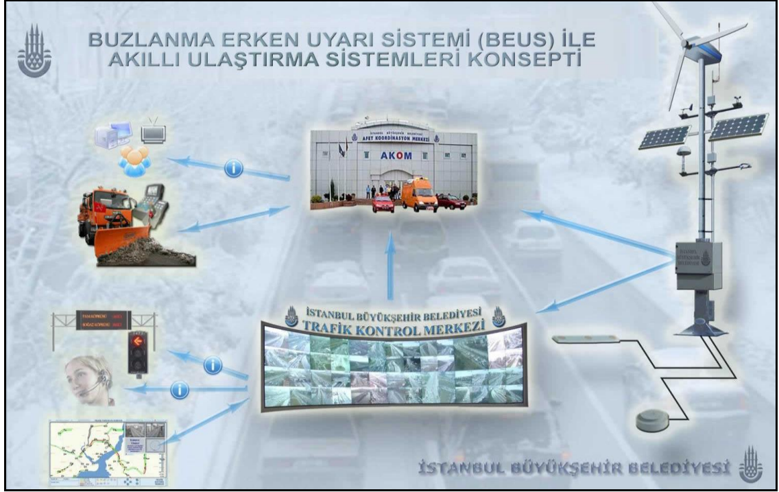
Şekil 3.15: Buzlanma erken uyarı sistemi (BEUS) çalışma prensibi
