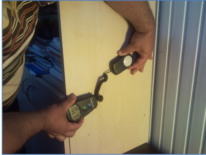
Şekil 11.5: Işık şiddetinin ölçülmesi
