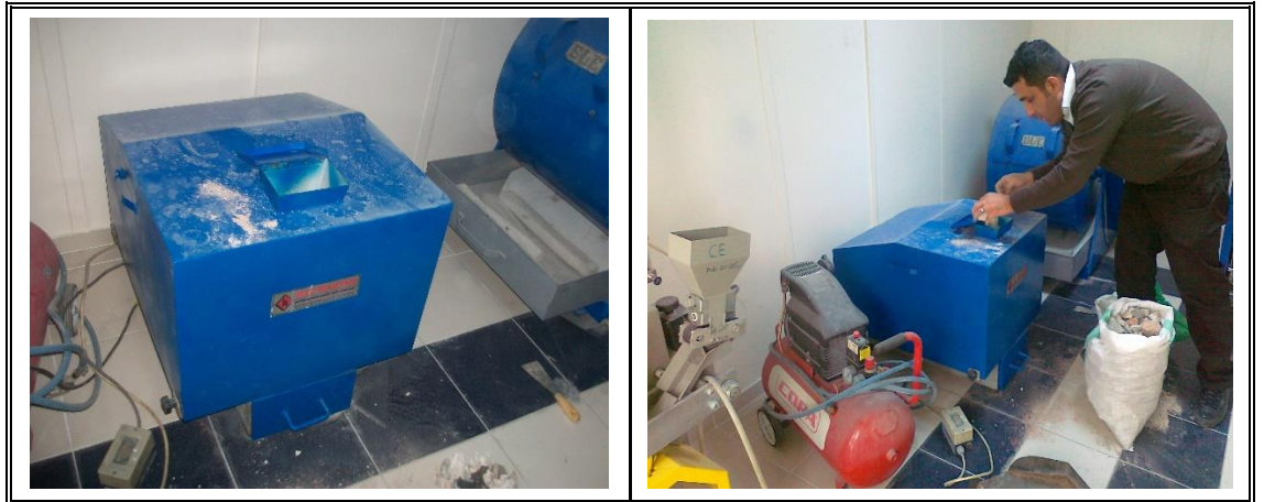
Şekil 6.4: Malzemenin konkasörden geçirilmesi
