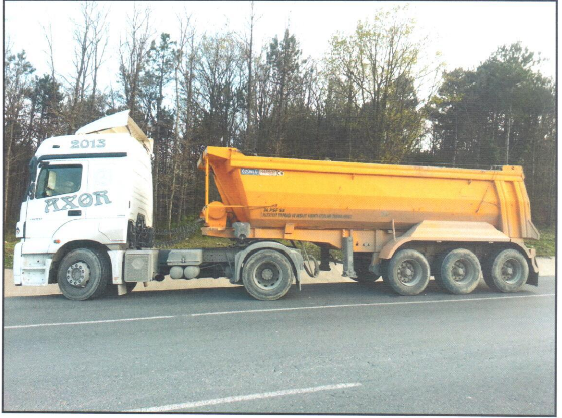
Şekil 3.3: Aksli 12 tekerlikli kırkayak 40 ton azami yük sınırlı yarı römorklu hafriyat tırı
