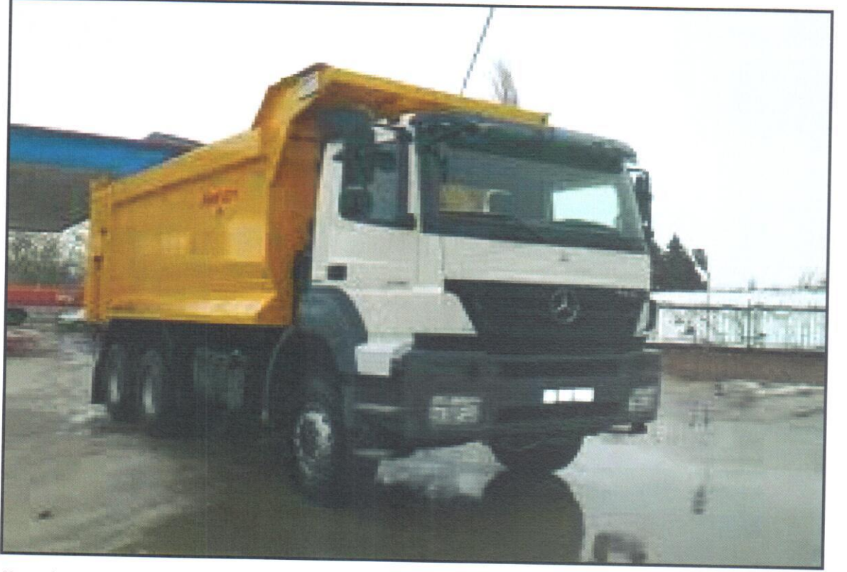
Şekil 3.1: 3 Akşlı 10 tekerlikli 26 ton istiap hadli hafriyat kamyonu
