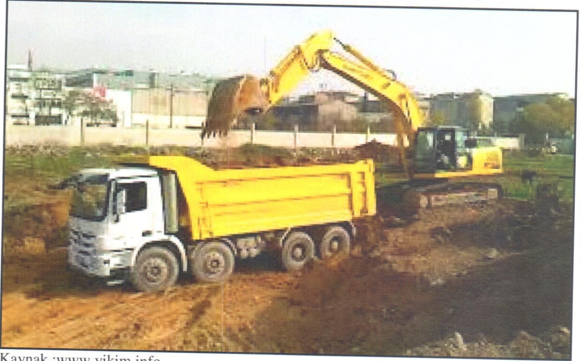
Şekil 3.2: Akşlı 12 tekerlikli 32 ton istiap hadli kırkayak hafriyat kamyonu
