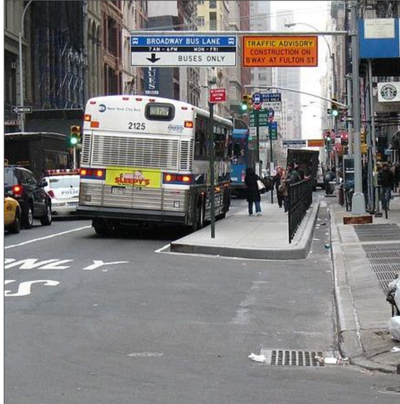
Şekil 4.15: Broodway Canal Caddesindeki Bus Bulbs örneği
