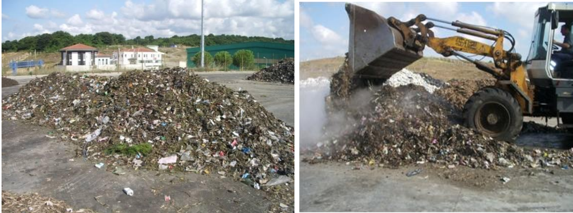
Şekil 3-12 : Aktarmalı yiğın ve aktarmalı yiğında karıştırma işlemi
