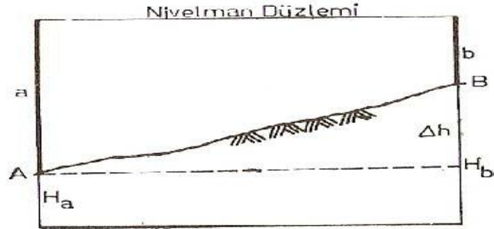
Şekil 2.4: Geometrik yükseklik ölçümünde nivelman düzleminde
