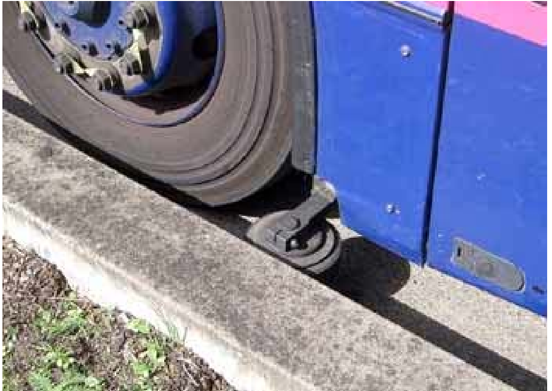
Şekil EK 3.3: Mekanik Yönlendirme tekerlekleri: Mannheim (Almanya)
