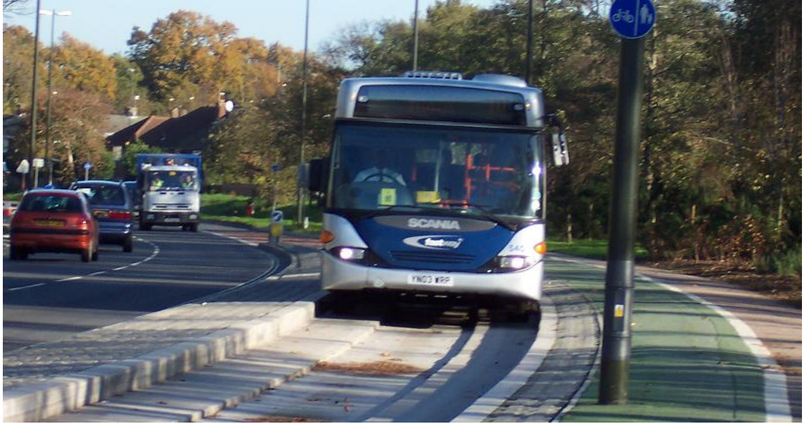
Şekil EK 3.2: Mekanik kılavuzlama ile aracın yol alması: Crawley, Londra
