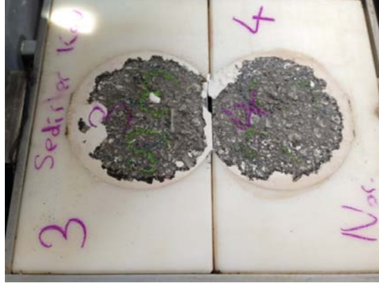
Şekil Ek C.16: Konya Sedirler Kavşağı katkısız aşınma tabakası karot numunelerin tekerlek izi deneyi öncesi durumu
