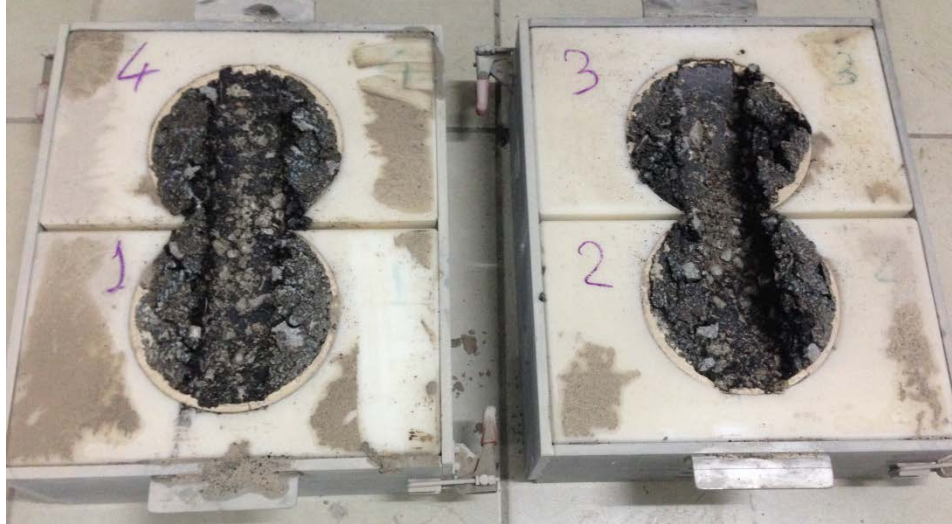
Şekil Ek C.11: Konya Azerbaycan Caddesi normal aşınma tabakası karot numunelerinin tekerlek izi deneyi sonrası durumu
