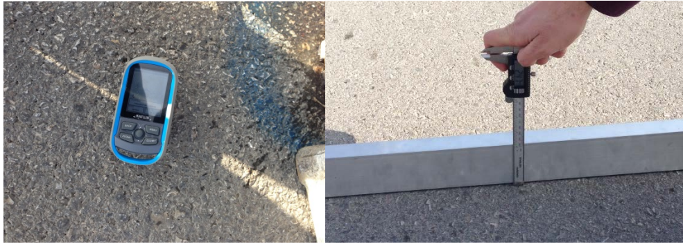
Şekil Ek A.18: Karot numunelerin GPS ile koordinatların belirlenmesi
