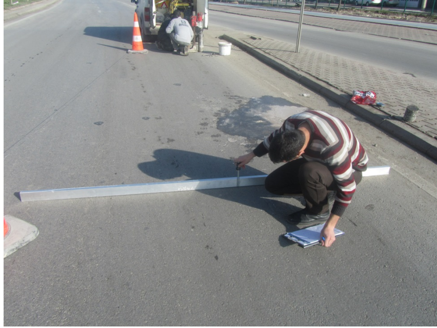
Şekil Ek A.17: Mastar ile tekerlek izi derinliğinin ölçülmesi
