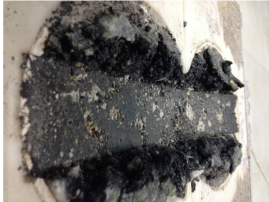
Şekil Ek C.18: Tekerlek izi deneyi sonrası karot numunelerde oluşan tekerlek izi derinliği
