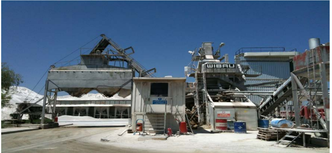
Şekil 4.3: Konya Büyükşehir Belediyesi’ne ait WIBAU marka 160 ton/saat kapasiteli asfalt planti.
