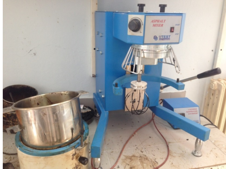
Şekil 6.14: Superpave deney numunelerinin mekanik karıştırıcıda karıştırılması
