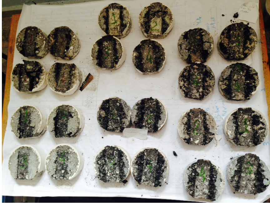
Şekil 6.8: Katkısız ve modifiye karot numunelerin tekerlek izi deneyi sonrası durumu
