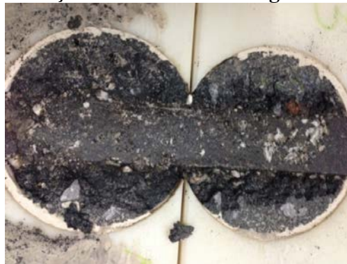
Şekil Ek C.9: Tekerlek izi deneyi sonrası karot numunelerde oluşan tekerlek izi derinliği
