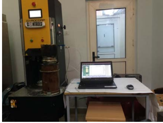
Şekil 6.10: Çalışmada kullanılan “GYROCOMP, GyrotoryCompactor” yağurmalı presi
