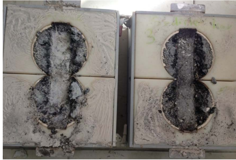
Şekil Ek C.8: Konya Adana Çevre Yolu modifiye aşınma tabakası karot numunelerin tekerlek izi deneyi sonrası durumu
