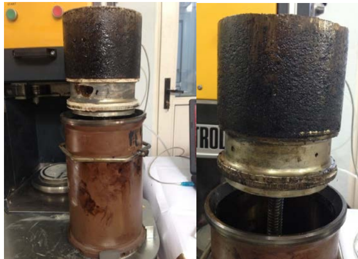
Şekil 6.15: Yoğurmalı sıkıştırıcıdan numunenin çıkarılması
