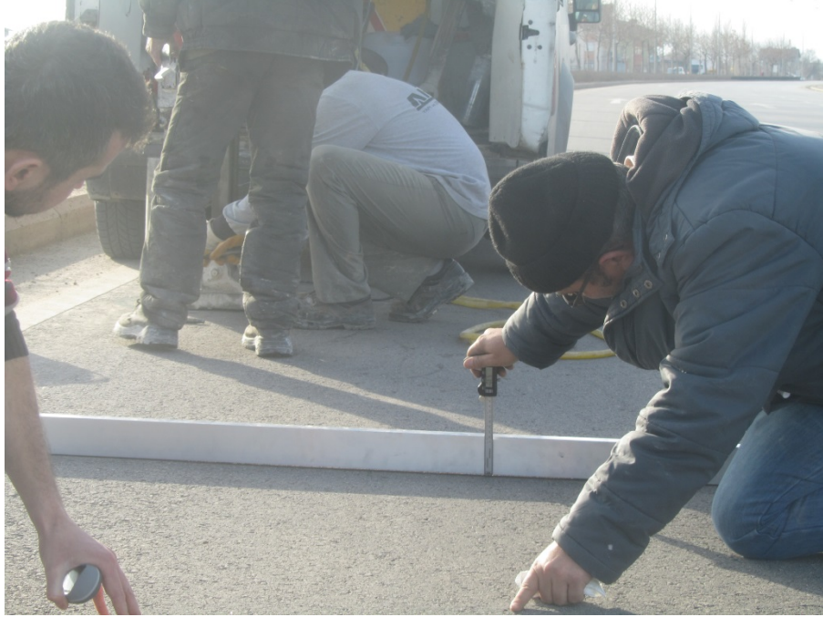
Şekil Ek A.11: Mastar ile tekerlek izi derinliğinin ölçülmesi
