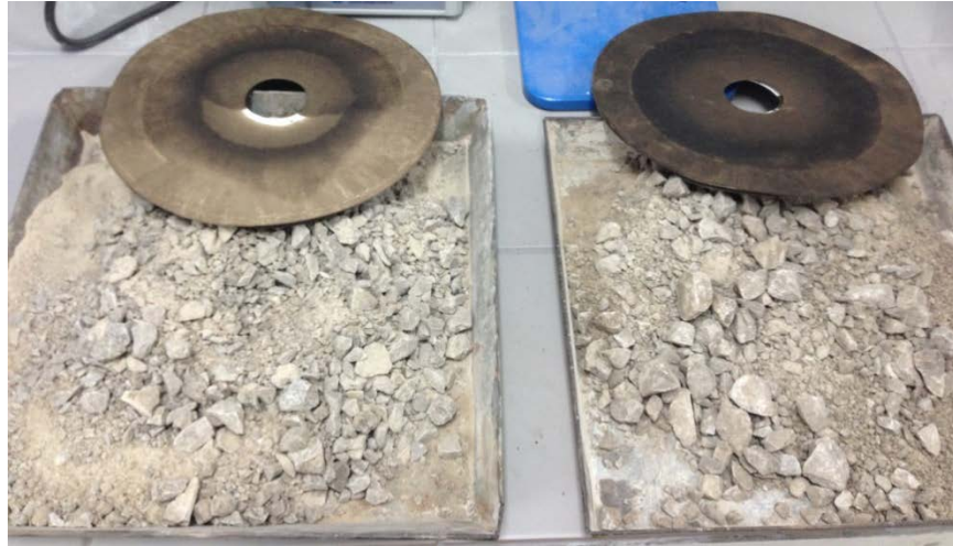
Şekil 6.2: Aşınma tabakası bitümü alınmış karot numuneler
