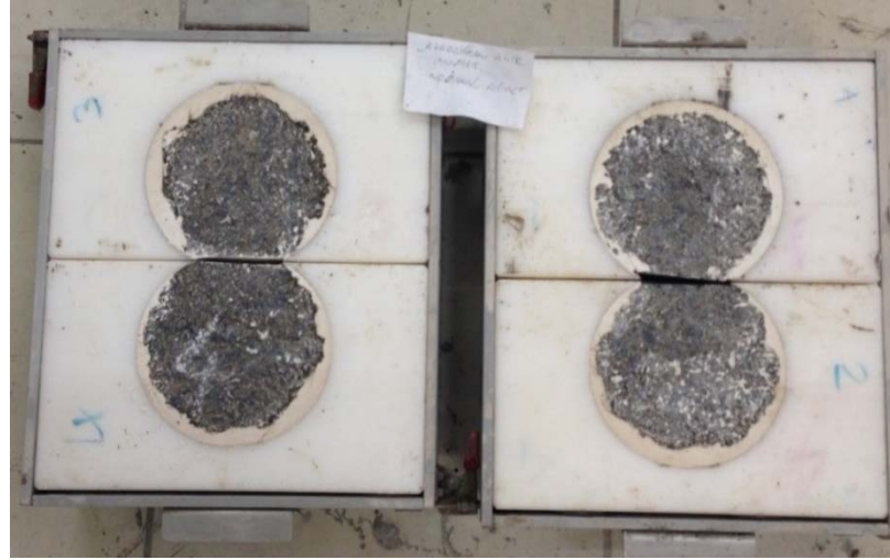
Şekil Ek C.13: Konya Azerbaycan Caddesi normal aşınma tabakası karot numunelerinin tekerlek izi deneyi öncesi durumu (1 nolu güzergah)
