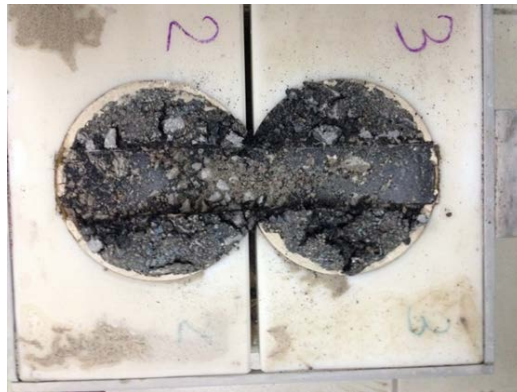
Şekil Ek C.12: Tekerlek izi deneyi sonrası karot numunelerinde oluşan tekerlek izi derinliği
