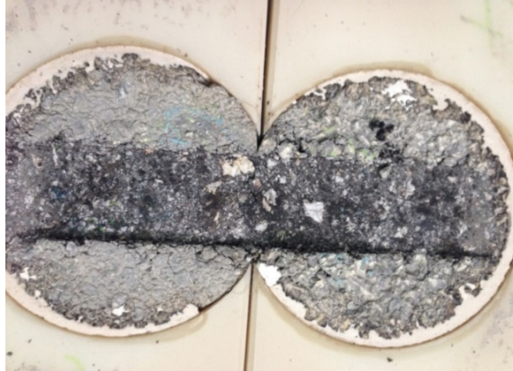
Şekil Ek C.3: Konya Ereğli Yolu tekerlek izi deneyi sonrası karot numunelerde oluşan tekerlek izi derinliği
