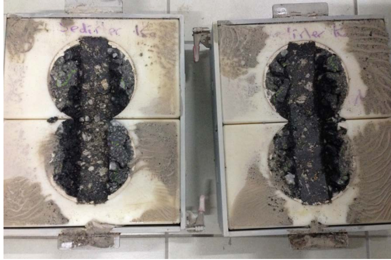
Şekil Ek C.17: Konya Sedirler Kavşağı katkısız aşınma tabakası karot numunelerin tekerlek izi deneyi sonrası durumu
