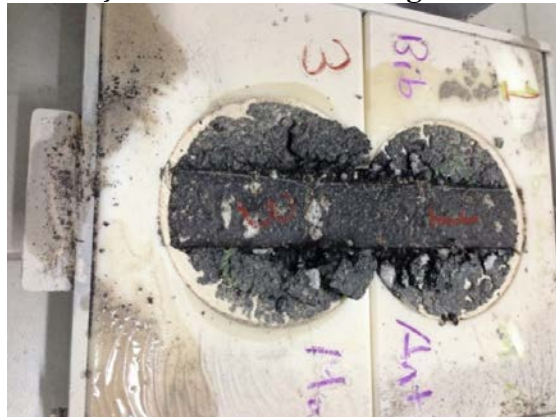
Şekil Ek C.6: Tekerlek izi deneyi sonrası karot numunelerde oluşan tekerlek izi derinliği
