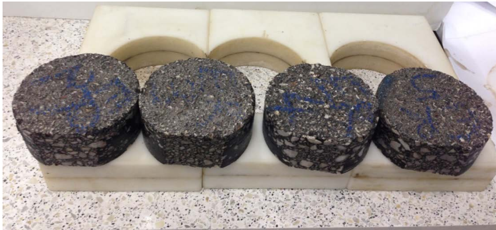
Şekil 6.7: Referans kalıba uygun hale getirilen karot numuneler ve kesitleri
