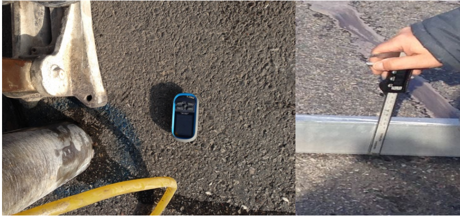
Şekil Ek A.12: Karot numunelerin GPS ile koordinatların belirlenmesi
