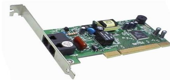
Şekil 2.22 : Dahili (DialUp) modem
