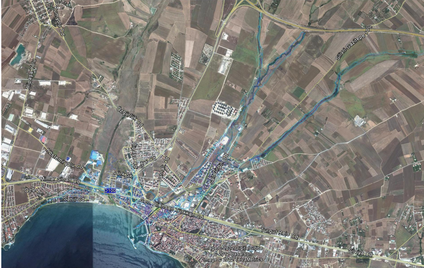
Şekil 5.37: Hava Fotoğrafi üzerinde Silivri Boğluca ve Tuzla Dereleri Taşkın Alanlarında Su Basman Çalışması
