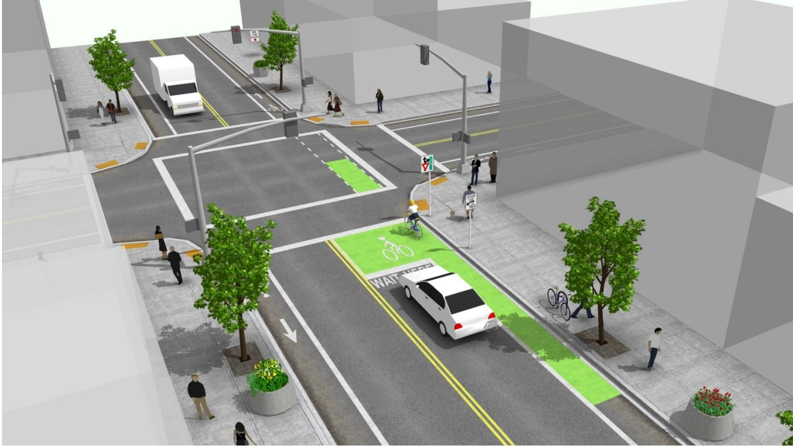
Şekil 4.43 Kavşaklarda Bisiklet Şeriti Uygulaması ve Bisiklet Güvenliğine ilişkin sinyalizasyon sistemi-1 (Kaynak: National Association of City Transportation Officials Bisiklet Yolu Tasarım Klavuzu)
