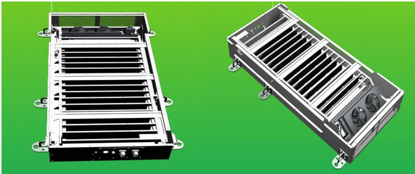
Şekil 2.14: Hibrid elektrikli otobüste kullanılan enerji depolama sistemi
