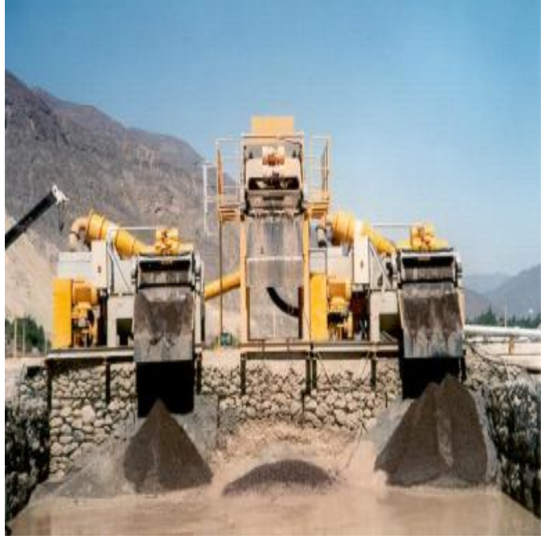
Şekil 5.16:Ayrıştırma Ünitesi BE 500
