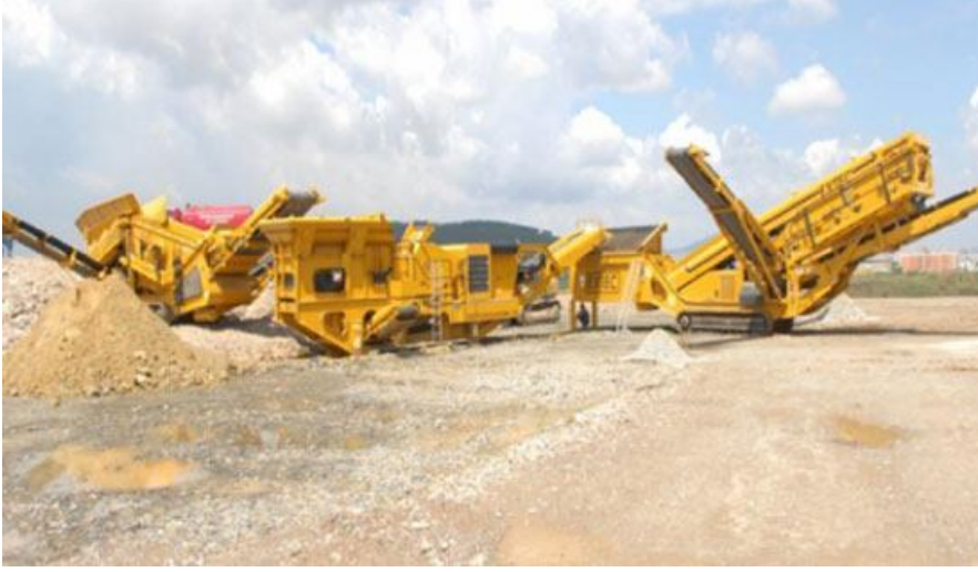
Şekil 2.4 : Geri kazanım tesisinde kırma-öğütme makinesi
