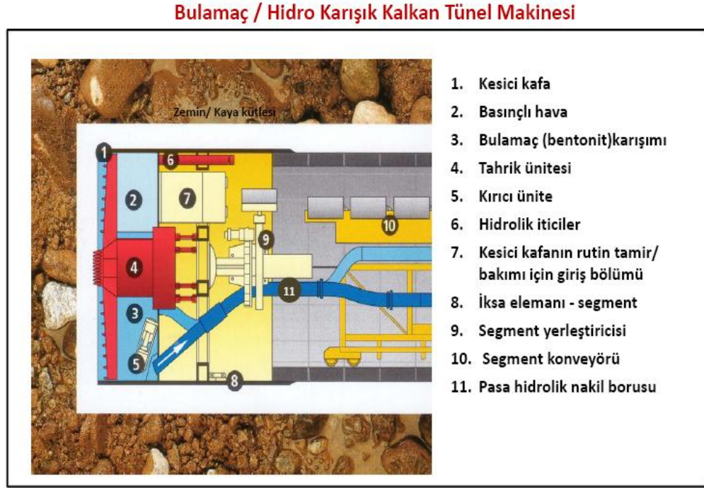
Şekil 3.5 : Bulamaç/Hidro karışık kalkan tünel makinesi
