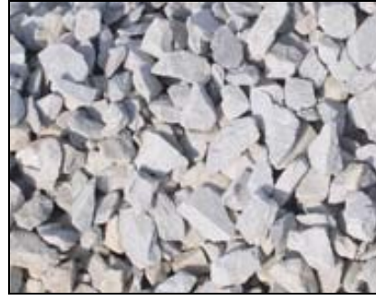
Şekil 2.6 : 3 No agrega (22-32mm) arası
