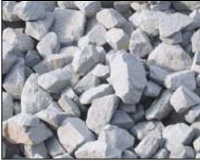
Şekil 2.7 : Kırma Taş (22-70mm) arası
