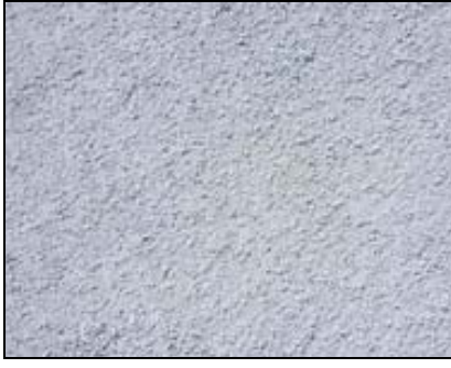
Şekil 2.3 : Taştozu (0- 5 mm) arası
