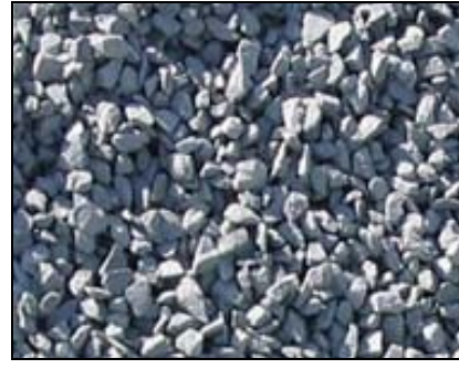
Şekil 2.4 : 1 No agrega (5-12mm) arası
