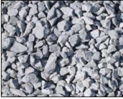
Şekil 2.5 : 2 No agrega (12-22mm) arası
