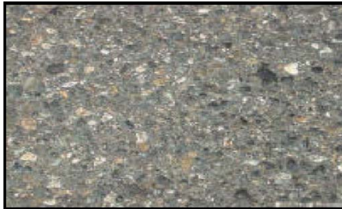
řekil 4.46: Cilalanmıř agrega
