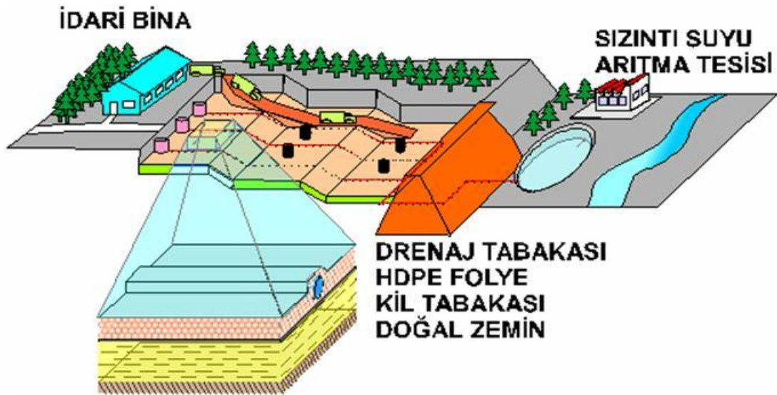
Şekil 4.9 : Düzenli Depolama Tesisi
