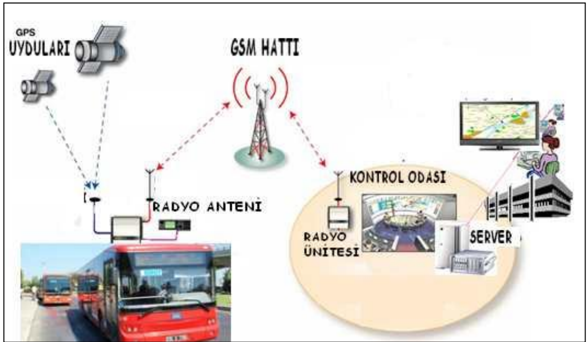
Őekil:3.1: Veri kaynađı sisteminin alıřma prensibi
