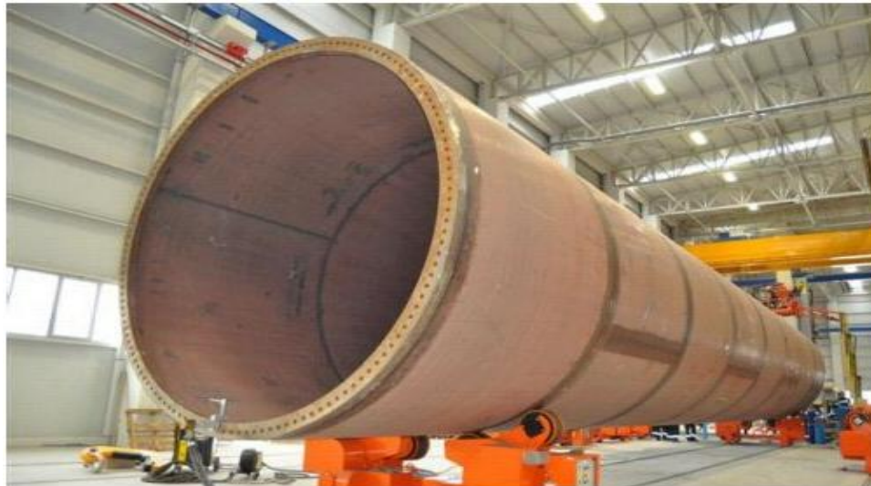
Şekil 5.12: Rüzgâr türbin kulesi
