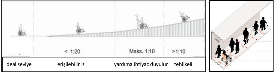
Kaynak: http://www.un.org , İstanbul Büyükşehir Belediyesi Özürlüler Müdürlüğü. Erişim tarihi: 21.04.2010 Şekil 4.6: Rampalarda güvenli eğim yüzde ve aralıkları
