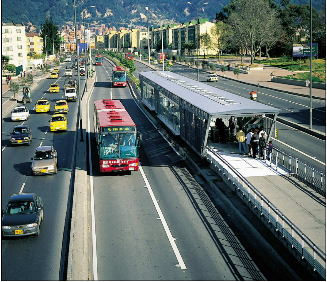
Şekil.26.1 Transmilenio BRT hattı. 2x2 yollar kullanılmıştır. (Bu uygulama sonucunda ortaya çıkan Transmilenio Metrobüs sisteminde 450 adet körüklü otobüs ile günde 800,000 kişi taşınmaktadır.)
