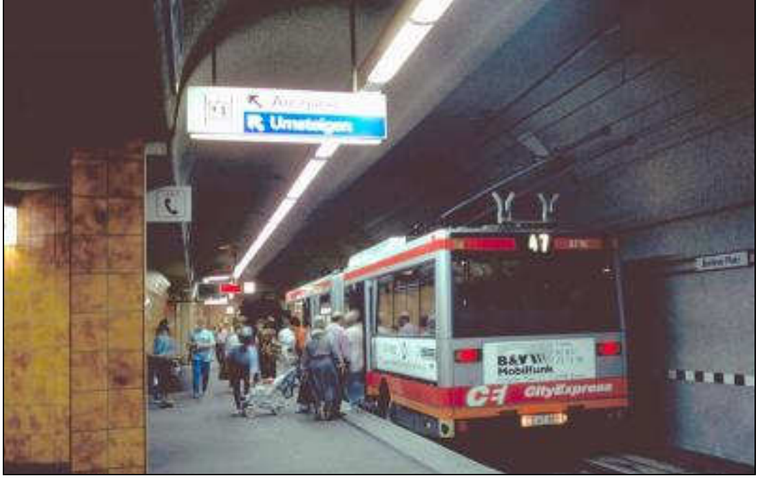
Şekil.34.1 Almanya Essen BRT hattı. Raylı sistem ve otobüsler aynı hat üzerinde çalışabiliyor.
