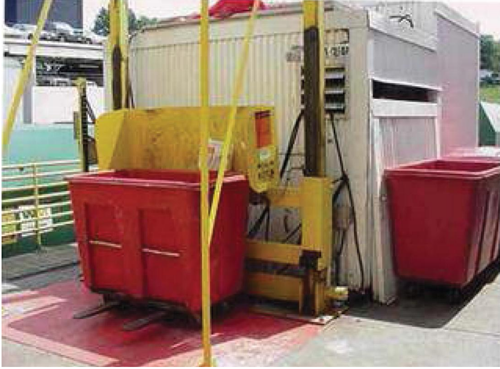
Şekil 4.4: Mikrodalga İşlemi Isı İletimi İle Tıbbi Atık Dezenfeksiyonu
