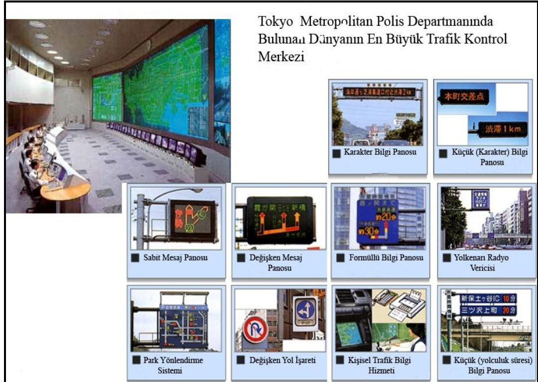
Şekil 3.5 : Tokyo Trafik Kontrol Merkezi ve saha elemanlarına ait görünüş
