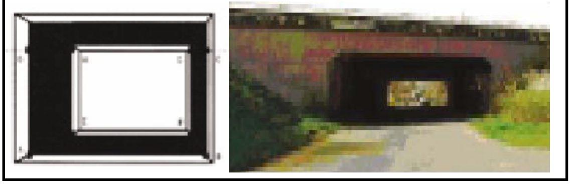
Şekil 3.2: Kısa mesafeli tüneller için “Karanlık Çerçeve” modellemesi
